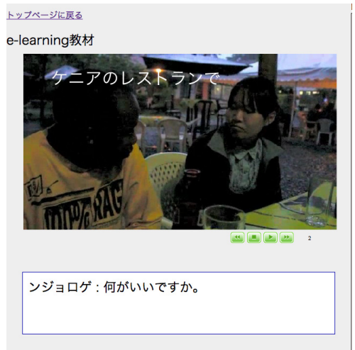
図3 状況を説明する字幕などはjavascriptで実装してあるため、データ上では動画そのものから切り離されており、教材に合わせて変更可能。
